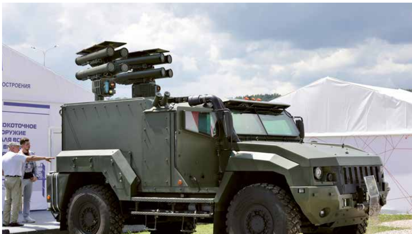
Противотанковый ракетный комплекс «Корнет-ЭМ» на шасси «Тайфун-К» АО «Конструкторское бюро приборостроения им. академика А.Г. Шипунова» (АО «НПО «Высокоточные комплексы» ГК «Ростех»)
